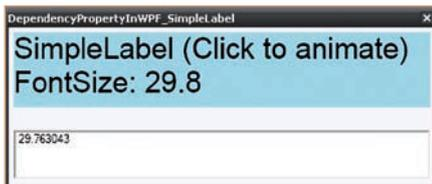
Abb. 4: Animation der FontSize – dank Metadaten wird bei jeder Änderung ein Rendering des SimpleLabel ausgelöst
