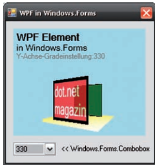
Abb. 6: Eine Windows-Forms-Anwendung mit einem WPF-User-Control mit 3D-Effekten
